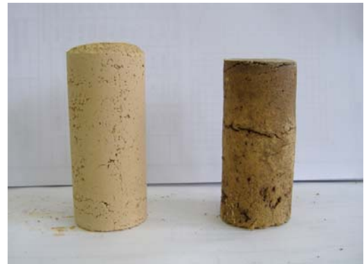
1) Abb. 24.1-2) zu 1: Probekörper mit drei unterschiedlichen Wassergehalten, ansteigend von links nach rechts / zu 2: Probekörper mit Zement-(links) und Wasserglaszuschlag (rechts).
