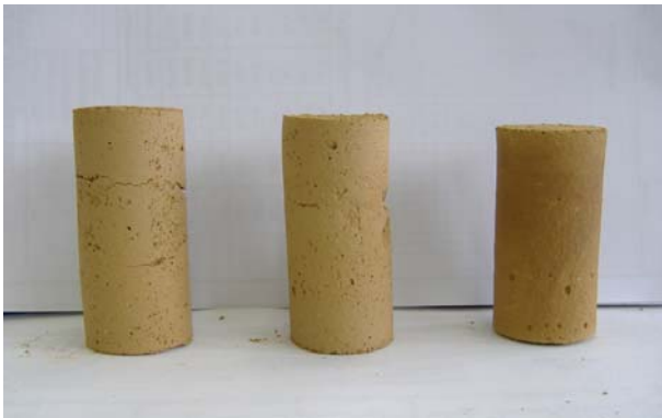
1) Abb. 24.1-2) zu 1: Probekörper mit drei unterschiedlichen Wassergehalten, ansteigend von links nach rechts / zu 2: Probekörper mit Zement-(links) und Wasserglaszuschlag (rechts).
