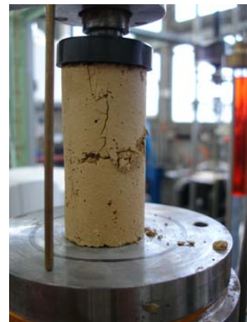
Abb. 25.1-3) zu 1: Versuchsaufbau / zu 2: Probe 7836.1 bei Versuchsbeginn / zu 3: Probe 7836.1 nach Versuchseintritt
